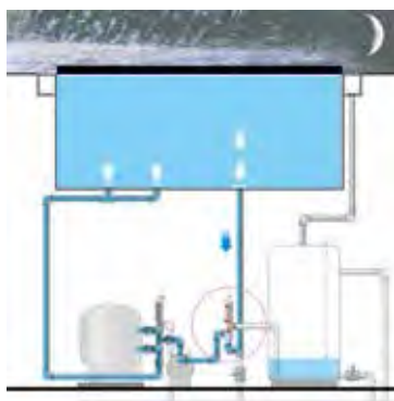
Spaarstand, afzuiging via bodemput i.p.v overloopgoot (buffer), indien afdekking gesloten is.
